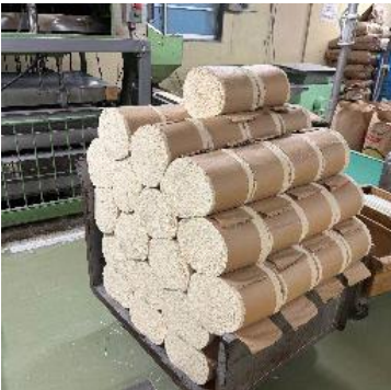
工程2：束にして移送 裁断後は人力で約8kgの束にし台車約70玉ほど積み、包装室へ移動する。1台の重さは560kgを超える重さ。重労働で離職が多い。
