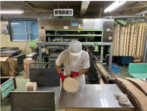
工程2：束にして移送 裁断後は人力で約8kgの束にし台車約70玉ほど積み、包装室へ移動する。1台の重さは560kgを超える重さ。重労働で離職が多い。
