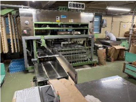
工程1：裁断 12時間かけて乾燥した麺は自動移行装置で裁断機に入り、18cmの長さにカットされ排出される。
