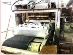
定量機を通し15kgに計量した後、冷凍パン、段ボールに排出
